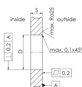
Dimensions de raccordement des appareils
